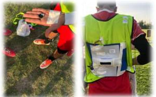
صورة (3) توضح طريقة تثبيت جهاز (Movement time)
