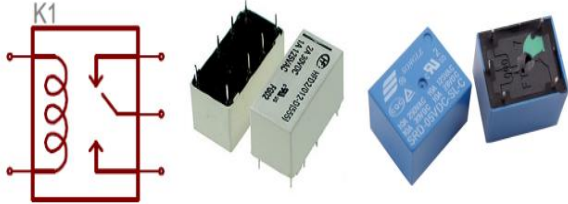
صورة (16) توضح المرحلات
