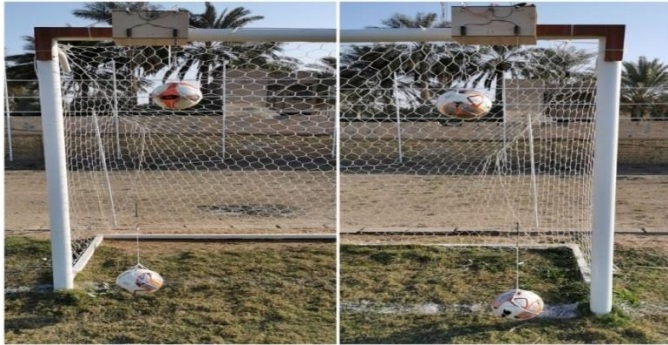
صورة (5) توضح لوحة تثبيت المتحسسات في جانبي المرمى
